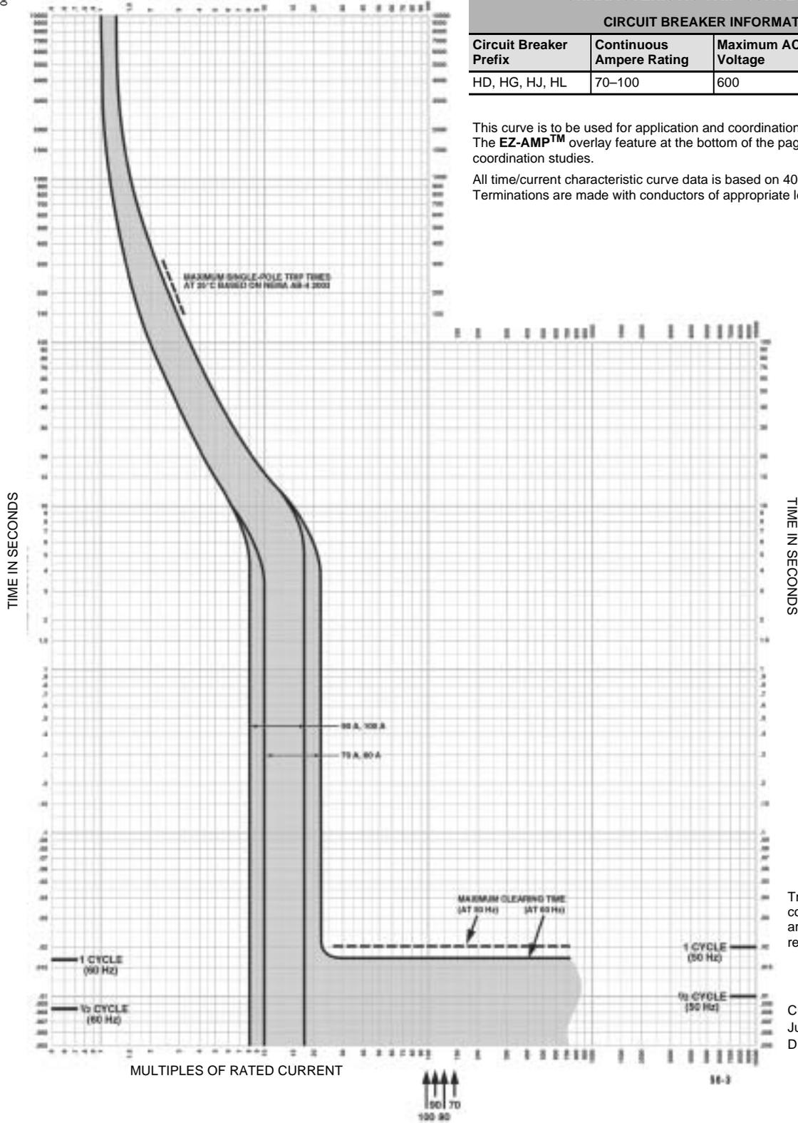
**POWERPACT® H-FRAME MOLDED CASE CIRCUIT BREAKERS
