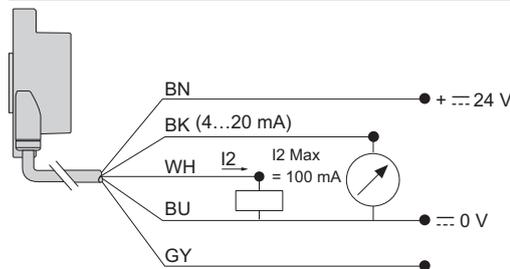
4...20 mA: load  $\leq$  250  $\Omega$  ( $\overline{\text{---}}$  12 V), load  $\leq$  850  $\Omega$  ( $\overline{\text{---}}$  24 V).
